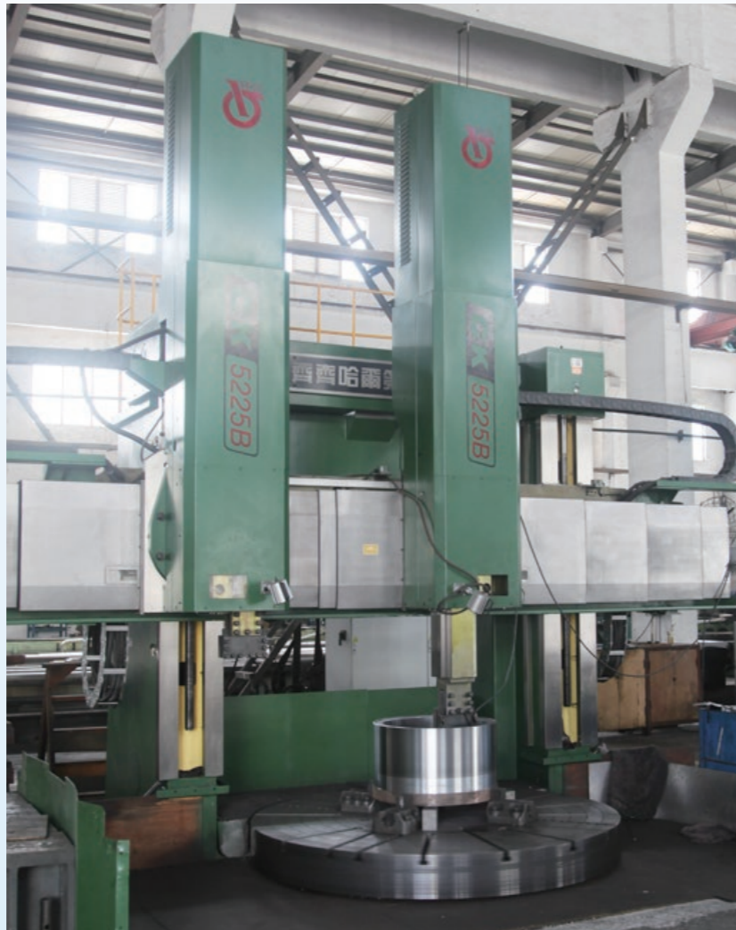
CK5225B*16/12G-NC 数控双柱立式车床 加工范围：直径 2500mm，可承载 15 吨的工件
