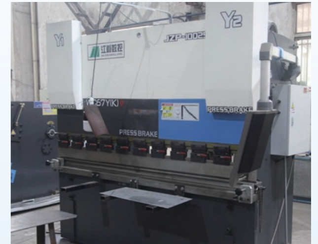
WC67K-100T/2500 数控液压板料折弯机
