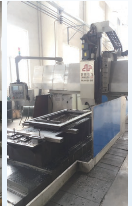
XK24125-250 数控龙门铣床 (2 台) 工作台：1500mm*2500mm
