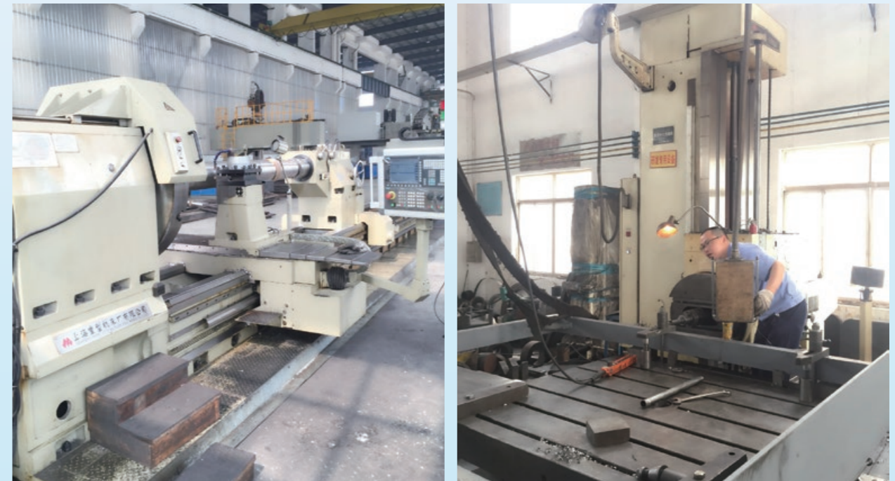
CK61160 数控卧式车床 加工范围：Ø1600mm×8000mm， 可承载 15 吨的工件
