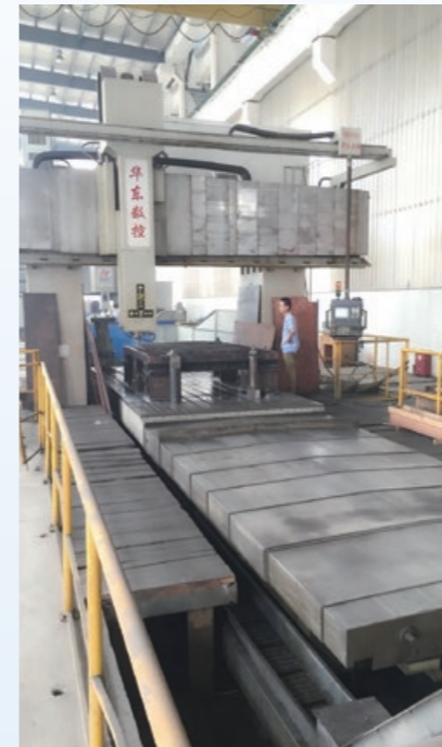
XKW2425*60 数控龙门铣床 工作台：2500mm*6000mm，可承载 60 吨的加工件
