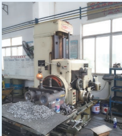
TX619T 卧式铣床 加工范围：主轴直径 90mm，可承载 2 吨的工件
