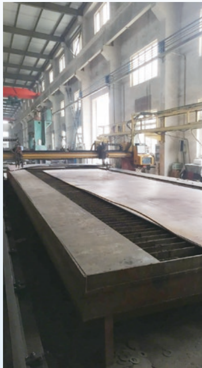
CNCSG-5000 数控等离子火焰切割机 (3台) 加工范围: 跨距 5000mm, 切割宽度 4200mm, 有效行程 12000mm, 切割厚度 6-120mm 切割速度 50-750mm/min
