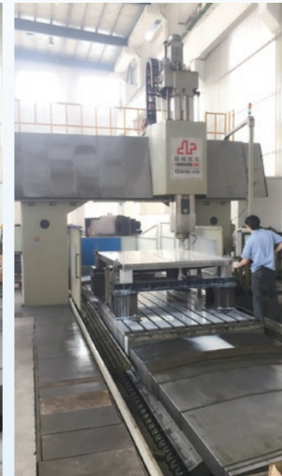
XK2420-400 数控龙门铣床 工作台：2000mm*4000mm，可承载 30 吨的加工件
