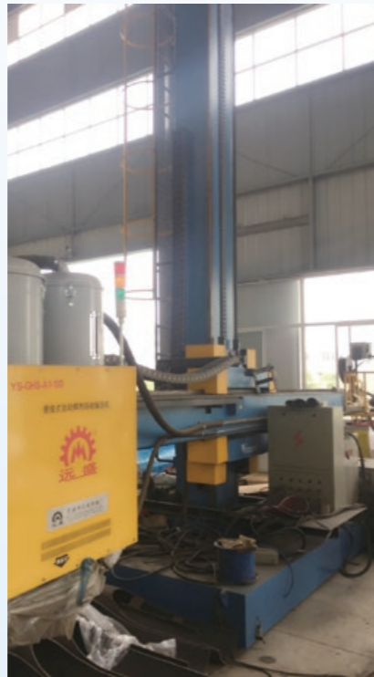
自动埋弧焊架 垂直升降行程: 5000mm 水平伸缩行程: 6000mm 横梁升降速度: 1000mm/min 横梁进给速度: 120-1200mm/min
