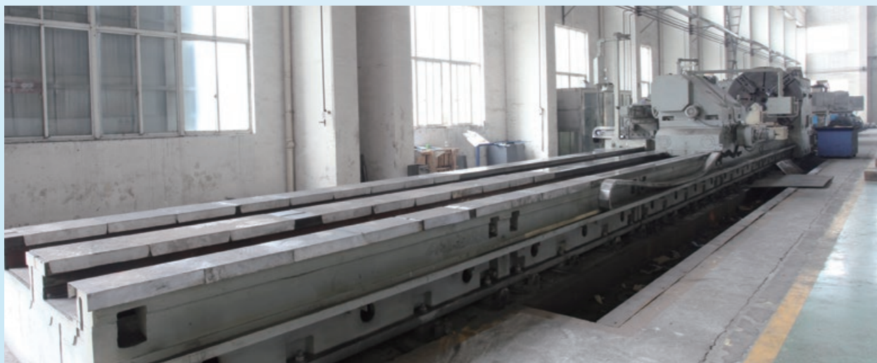
CK61600 重型数控卧式车床（加工范围： \varnothing 1600\text{mm} \times 16000\text{mm} ，可承载 80 吨的工件）
