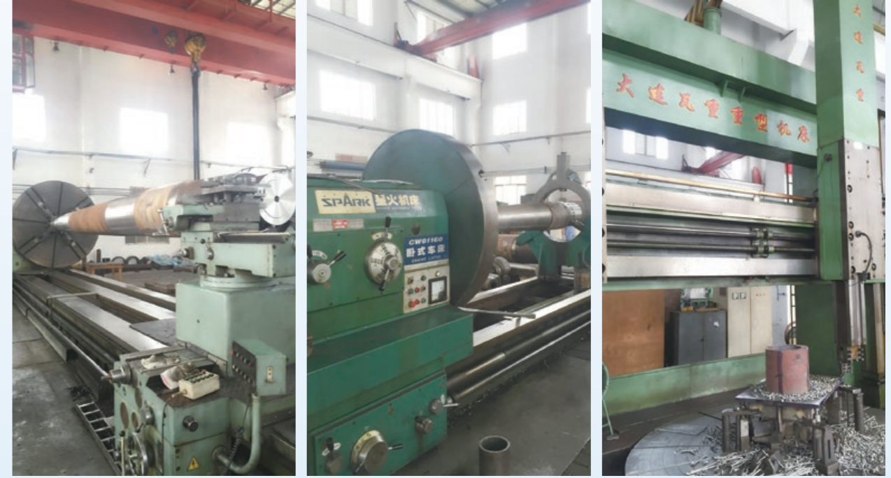
C61250×12 重型卧式车床 加工范围：Ø2500mm×12000mm， 可承载 72 吨的工件
