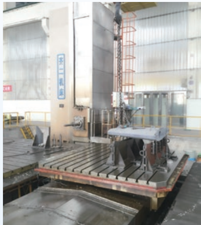
TK6916 数控落地铣镗床 加工范围：镗轴直径 160mm，铣轴直径 320mm，带全数控转台和意大利数控平旋盘，可实现七轴五轴联动，可承载 40 吨的加工件。
