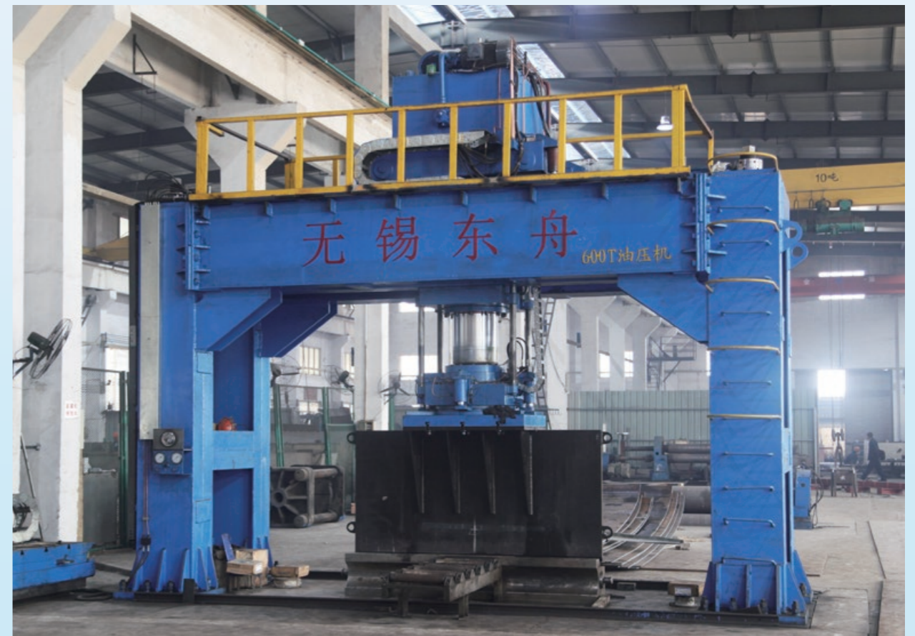
DZ-600T 油压机 (加工范围：板厚：6-50mm，板宽：3000mm)
