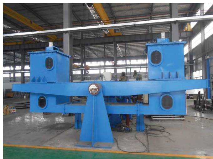
ARTDZ-A/W-SY 型抗横倾兼 减摇多功能水舱试验台
