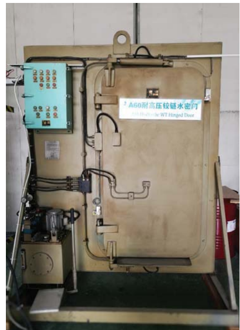
A60 级液压铰链式防火水密门 (981 石油钻井平台配套产品、 国家科技进步奖特等奖)
