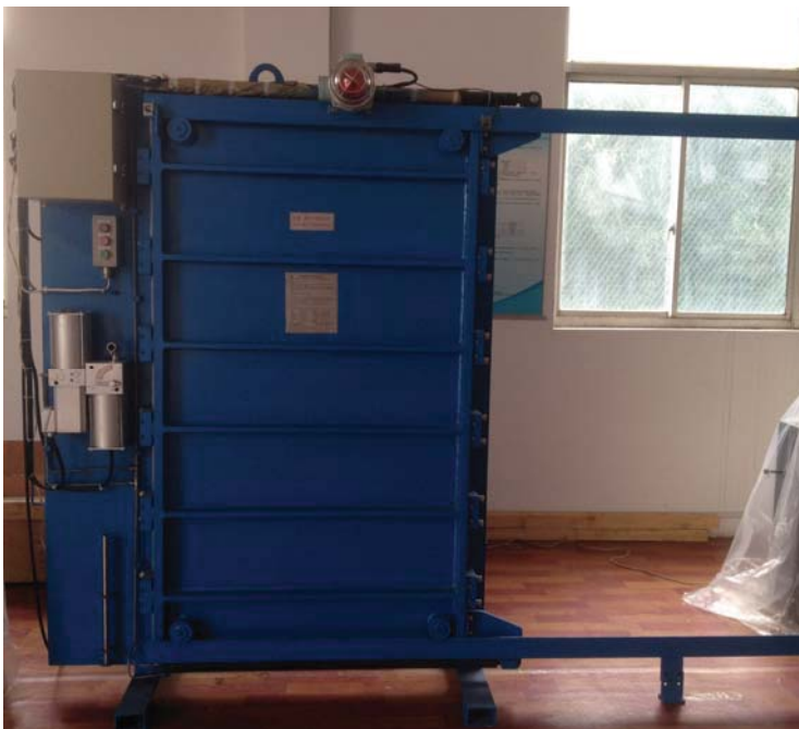
第三代液压滑动水密门 (世界首创, 国际最先进水平, 装备于海洋石油 982 项目)
